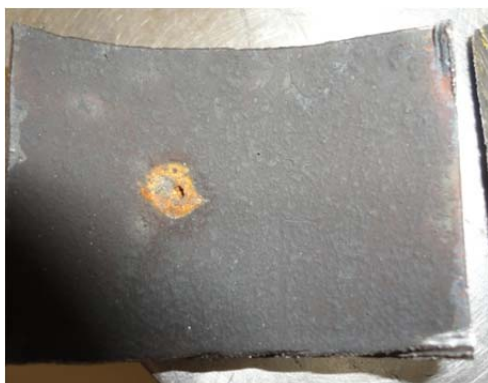
Figura 9 - Pite isolado de pequenas dimensões, dificilmente seria detectado por IRIS
