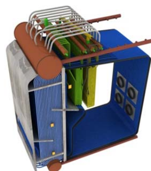
Figura 2 - Desenho de uma caldeira "aquatubular"
